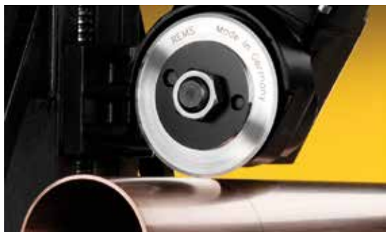
Las cuchillas de corte REMS se han adaptado a los requisitos específicos para los distintos materiales. Sobre todo el proceso de endurecimiento especial decide la larga duración de las cuchillas de corte REMS.
